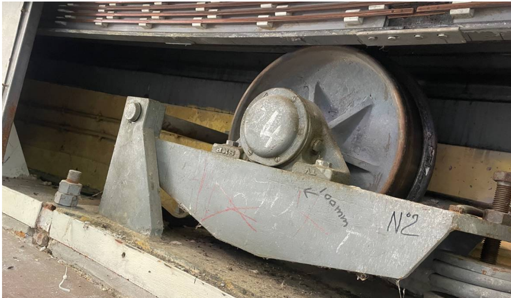
Figure 26 : Roues fixées au sol sur dalle bétons
